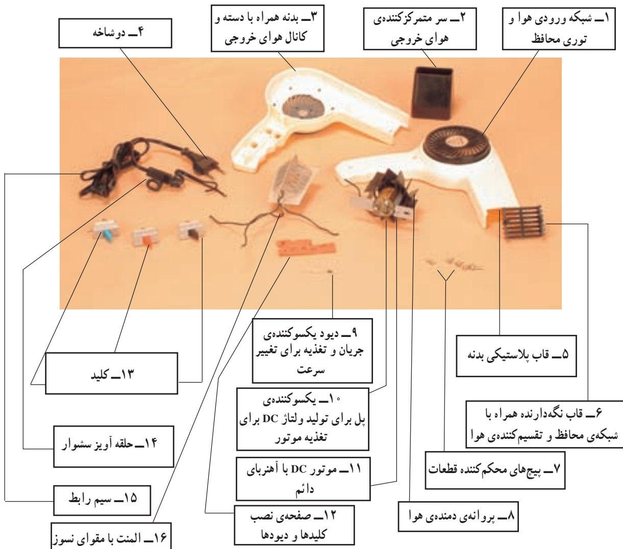
شکل ۴۲-۶ اجزای ساختمانی یک نمونه سشوار
