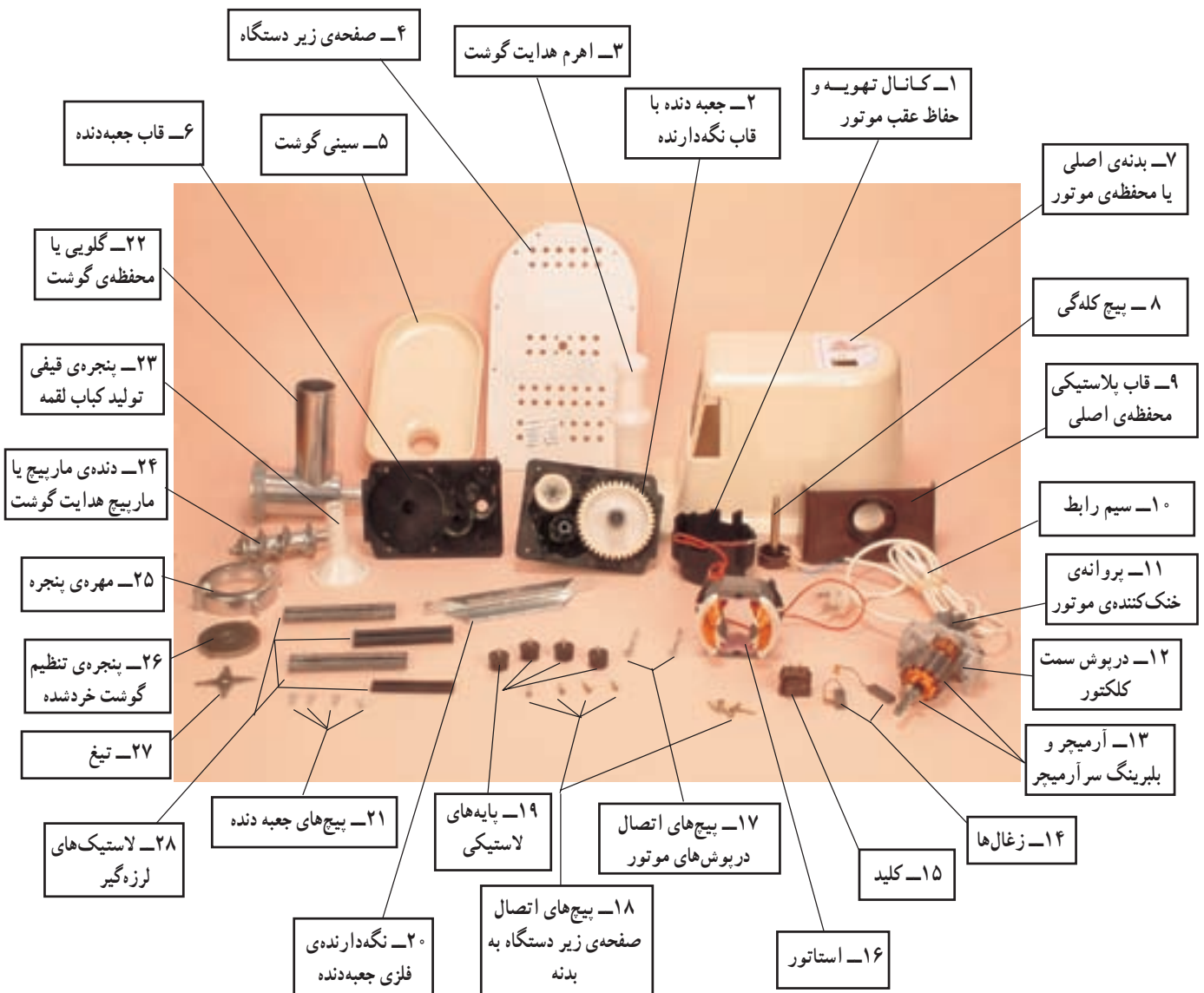
شکل ۳-۴۸- اجزای ساختمانی یک نمونه چرخ‌گوشت
