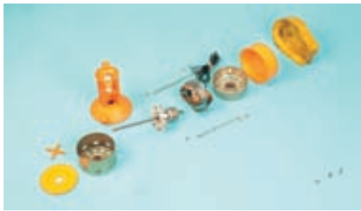
شکل ۱۸-۸ - نمایش ظاهری و اجزای یک واترپمپ
