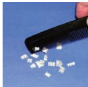
▶ شکل ۱۰۷-۲ ایجاد الکتریسیته ساکن در اثر اصطکاک
